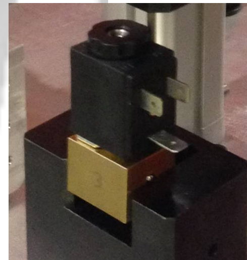
Componenti tarabili sostituendo semplicemente degli adattatori economici ed a cambio rapido.
